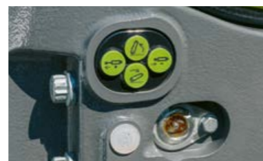
Comando esterno per sollevatore anteriore e un distributore con allestimento CEBIS.
