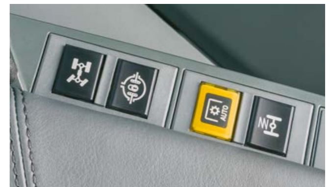
Attivazione della sospensione dell'assale anteriore
